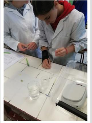
**3<sup>ème</sup> :** TP de Chimie sur la mesure de pH (potentiel hydrogène) de 4 solutions : eau du robinet, jus de citron, vinaigre et Javel.
